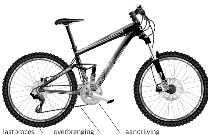
Figuur 1.1 Aandrijving, overbrenging en lastproces voor de fiets (foto: Shutterstock/Ovchinnikov Vladimir)
