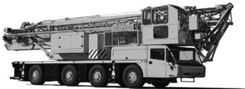
Figuur 1.3 Spierings mobiele torenkraan (foto: Spierings Mobile Cranes B.V.)
